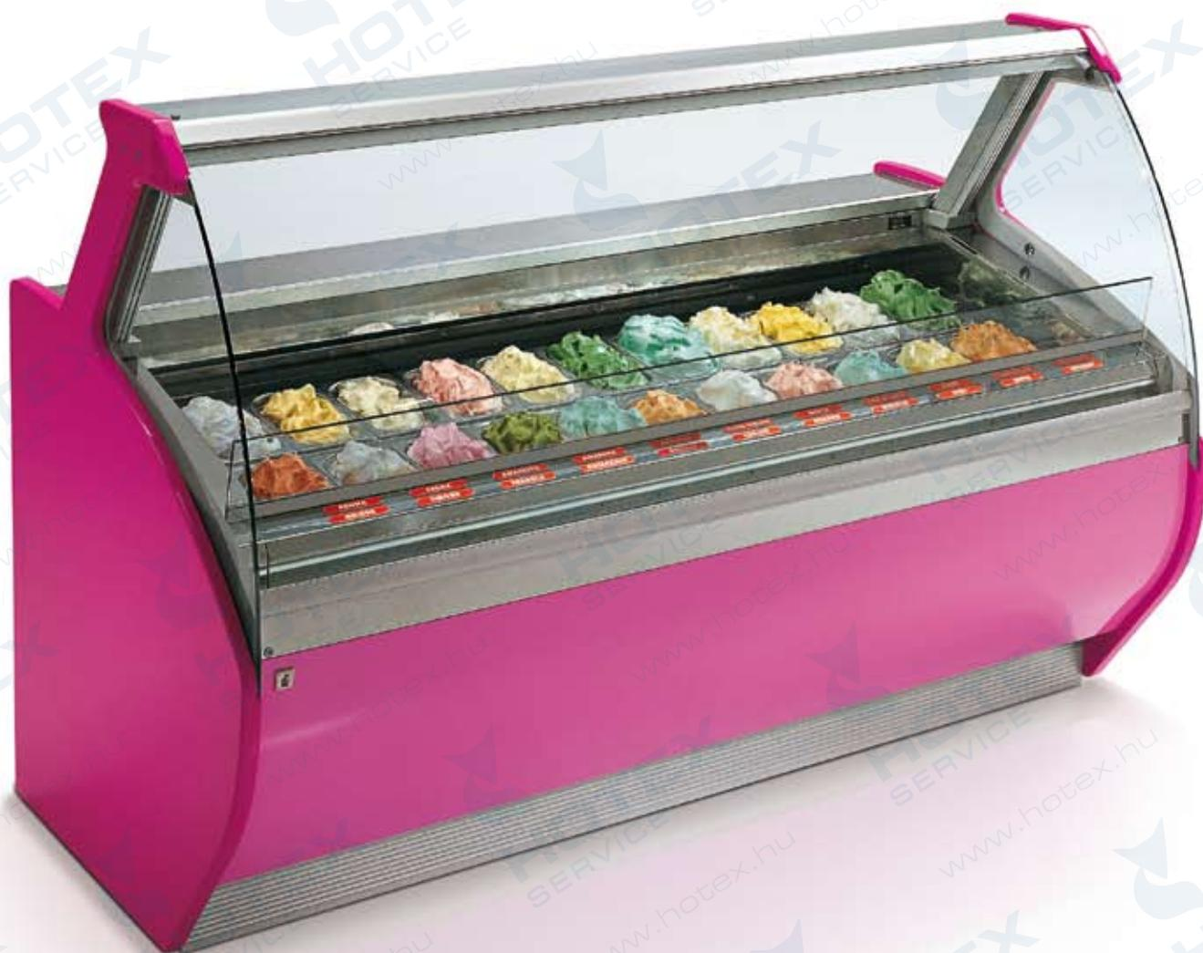
*Deliziosa nelle sue misure, testata in camera climatica a +35°C e 60% umidità relativa, Sky è dotata di refrigerazione ventilata, con sbrinamento a gas caldo, a cicli di 8 ore. Il vetro curvo anteriore è apribile verso il basso, i vetri frontali e laterali sono temperati. Lavapozzionate e ruote sono optional.*
